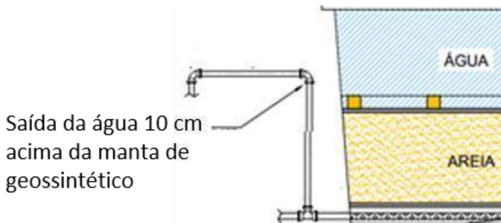
Figura 13: Detalhe da saída da água do reservatório utilizado para construção da unidade filtrante
