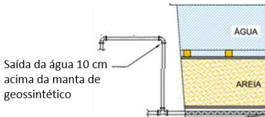
Figura 11: Detalhe da saída da água do reservatório utilizado para construção da unidade filtrante
